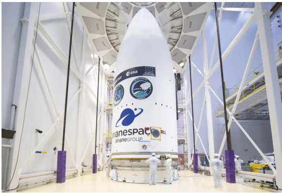
Das Upper Composite der Ariane 6 beherbergt die Nutzlast.
