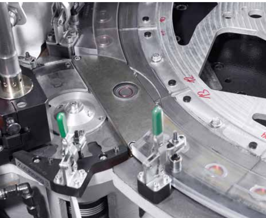
Herzstück der Füge-Maschine – zu sehen: Transportteller mit den Zahlen, der die Plättchen transportiert, die dann eingefügt werden.
